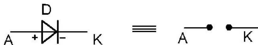
Hình 3-14. Mạch TĐ khi diode PCN của diode lý tưởng.
